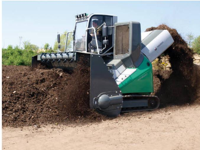
Abbildung 3-3: Kompostumsetzer vom Typ Neuson Ecotec
